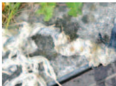
Grund der Verstopfung war immer eine größere Anzahl von Feuchtvliestüchern, Slipeinlagen und Tampons. Diese Gegenstände zersetzen sich nicht und wickeln sich wie ein Strick um das Laufrad und setzen die Pumpen außer Funktion (siehe Abbildungen).
